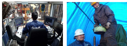
左写真：3,000 m級の井戸を掘ることができる掘削リグ
