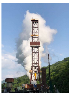
左写真：3,000 m級の井戸を掘ることができる掘削リグ
